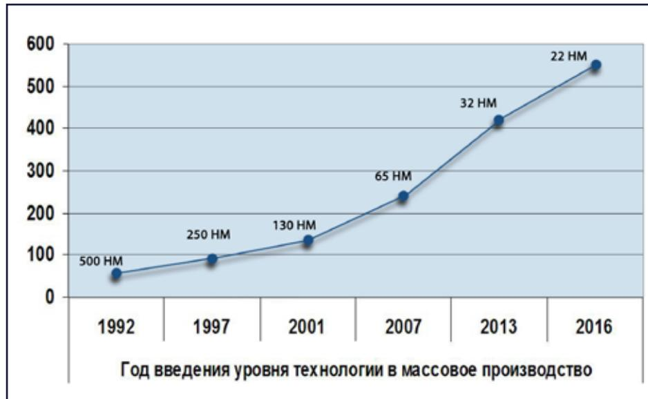
Рис. 4. Средняя стоимость завода по производству наносхем, млн. долл.
