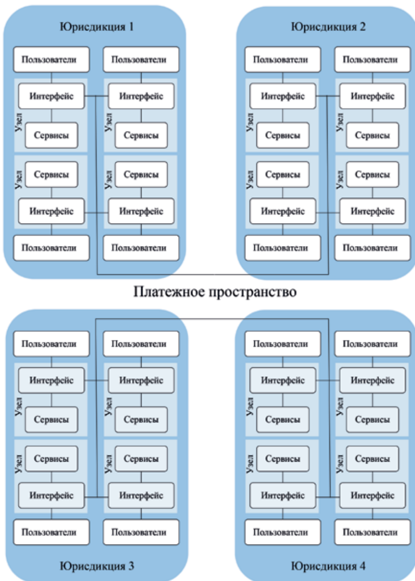
Рис. 4. Структурная модель децентрализованной трансграничной платежной инфраструктуры на основе технологии распределенного реестра
