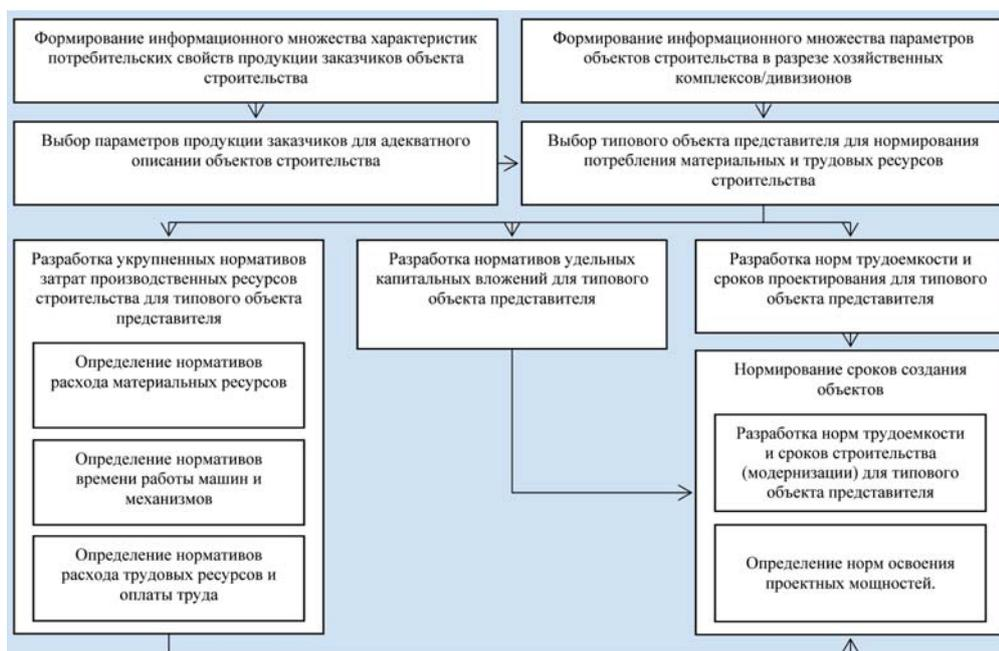
Рис. 2. Укрупненная структура алгоритма расчета нормативов
